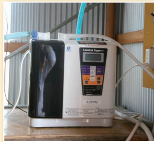
The Leveluk Super 501 unit that generates acidic electrolyzed water for disinfecting rice seeds 種籾の消毒用酸性電解水を生成するレベラックスーパー501
